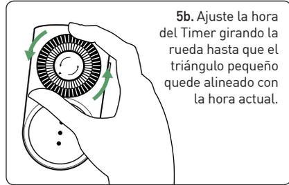
5b. Ajuste la hora del Timer girando la rueda hasta que el triángulo pequeño quede alineado con la hora actual.
